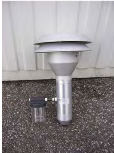
Abbildung 3: amerikanischer PM10-Probenahmekopf BX-802 für BAM-1020
