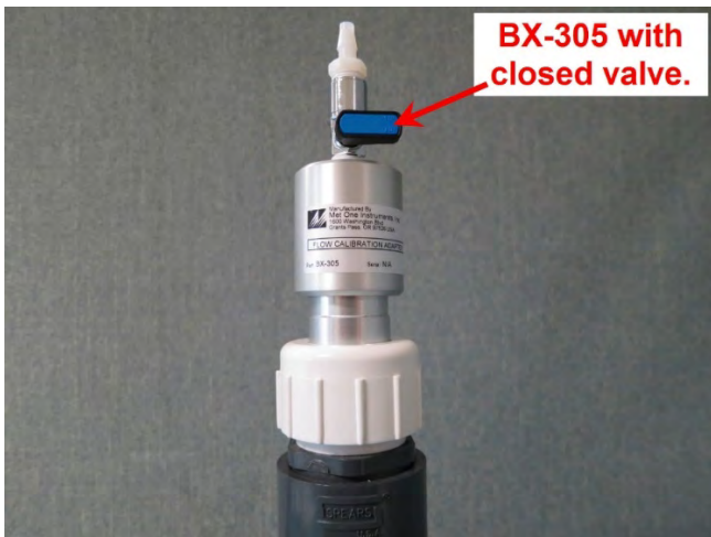
Abbildung 15 – Am Einlassrohr installiertes Leckrückschlagventil BX-305
