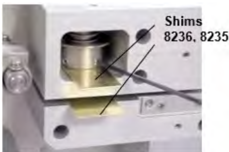
Abbildung 36 – Verwendung von Passplatten für den Zusammenbau
