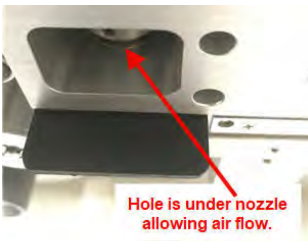
Abbildung 17 – Düsendichtungswerkzeug mit Bohrung unter der Düse
