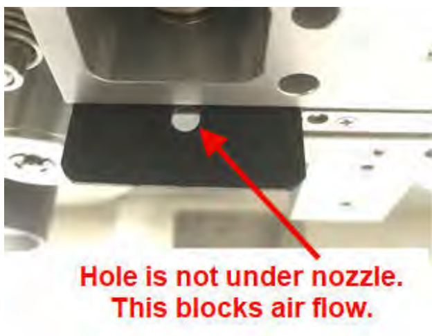
Abbildung 18 – Düsendichtungswerkzeug mit fester Seite unter der Düse
