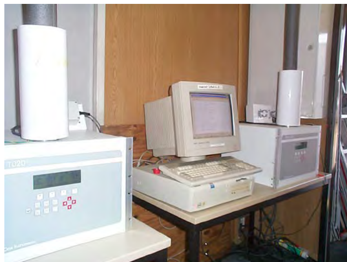
Abbildung 7: Messgeräte BAM-1020 in Messstation
