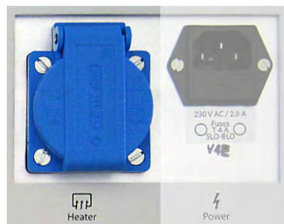
Abb. 5.6: Anschluss für Sondenrohrbegleitheizung beim F-701-20 („Heater“)
